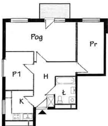
Rys. 16.12. Plan mieszkania 3PK (Pu – 67,4 m 2 ) przeznaczanego dla rodziny trzyosobowej, przedstawiony w stołecznej ofercie rynkowej w 2008 r., cechuje go nieuzasadniona zamiana położenia kuchni i pokoju jednoosobowego, co sprawia, że kuchnia staje się niefunkcjonalna. Urządzenie kuchni w miejsce pokoju jednoosobowego stworzyłoby możliwość połączenia jej drzwiami bezpośrednio z aneksem jadalnym w pokoju ogólnym. Powstałby w ten sposób wzorcowy układ funkcji K + Aj + Pog. Oznaczenia: H – hol, K – kuchnia, Ł – łazienka, Pog – pokój ogólny, Pr – pokój rodziców, P1 – pokój jednoosobowy.
