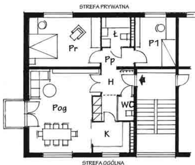
Rys. 18.1. Modelowy przykład układu funkcjonalno-przestrzennego mieszkania 3PK (rys. arch. W. Korzeniewski) opartego na podziale na wyraźnie wyodrębnione strefy: ogólną i prywatną (intymną).
